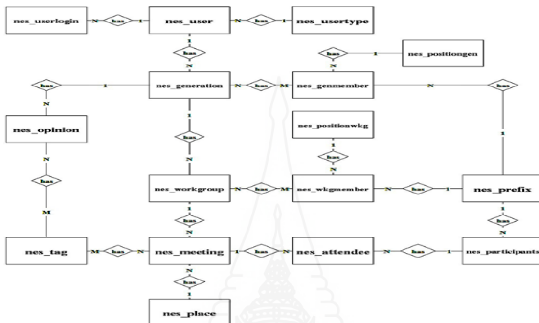
ภาพที่ 3 แบบจำลองข้อมูลอี-อาร์ (E-R model) ของระบบฐานข้อมูลเพื่อการจัดการสารสนเทศ งานประชุมและสัมมนาของสำนักงานสภาที่ปรึกษาเศรษฐกิจและสังคมแห่งชาติ
